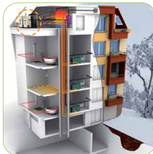
Esempio di applicazione in funzionamento estivo e invernale con impianto a pannelli radianti, fancoils, produzione indiretta ACS.
