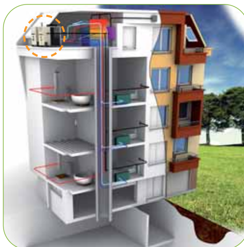
Esempio di applicazione in funzionamento estivo e invernale con impianto a pannelli radianti, fancoils, produzione indiretta ACS.
