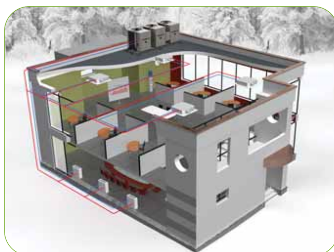
Esempio di applicazione presso degli uffici con impianto a fancoils e cassette a soffitto.
